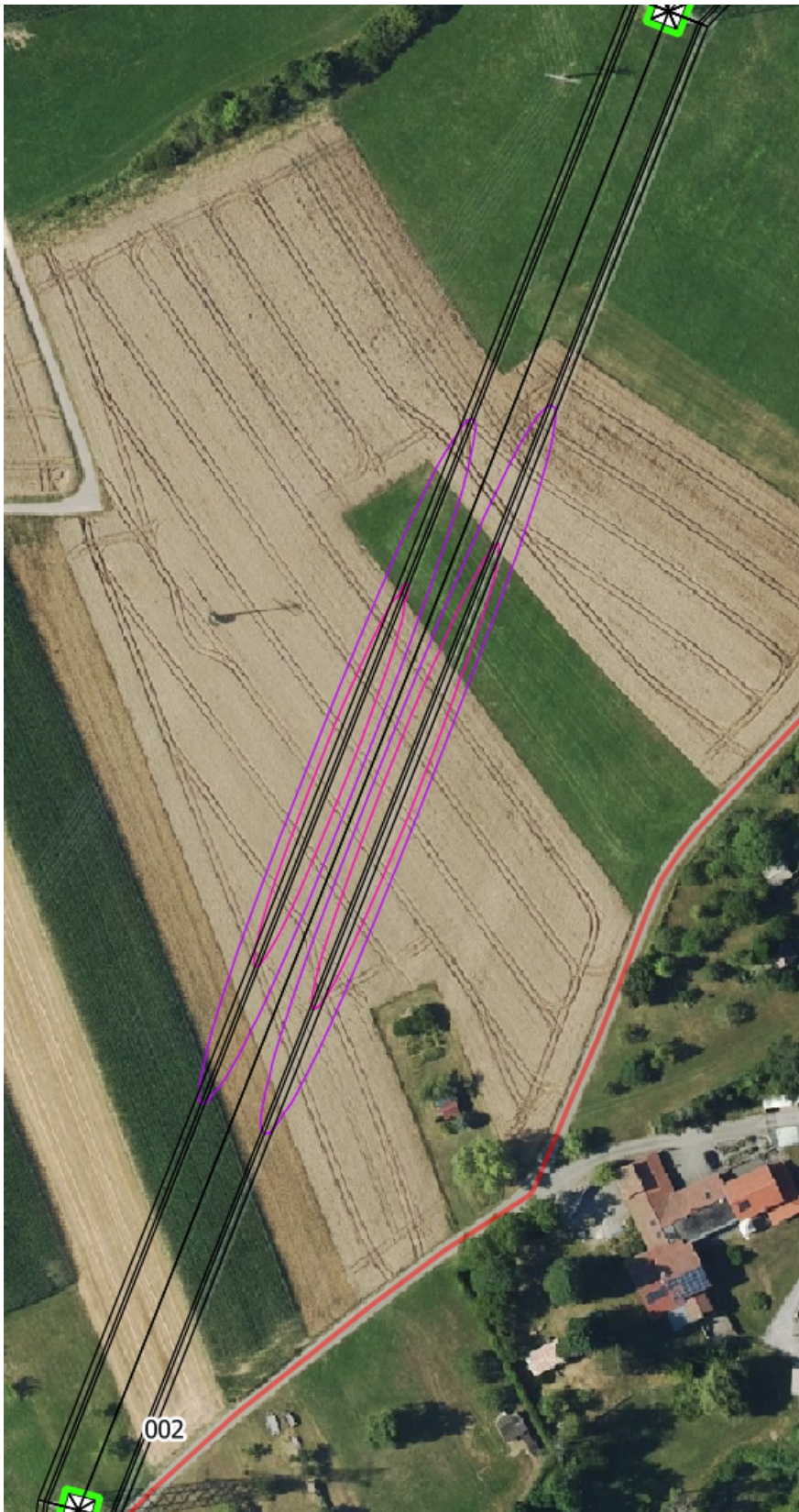
Abb. 17: Spannfeld Mast 001- Mast 002, mit Isolinien für 5 kV/m (lila Linie) und 7 kV/m (rosa Linie), der Maximalwert im Spannfeld beträgt 9,8 kV/m
