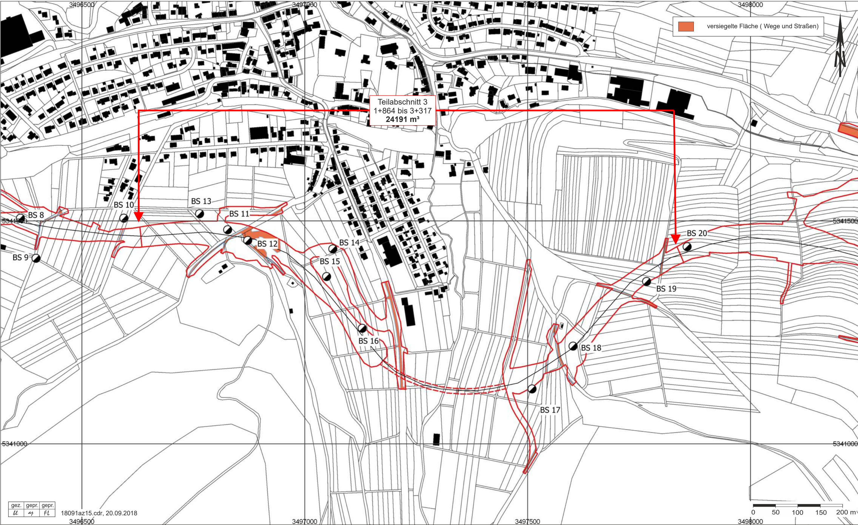
Lageplan mit den zu erwartenden Oberbodenmengen und der versiegelten Flächen im TA 3 Maßstab 1:5.000 Anlage 1.5.3
