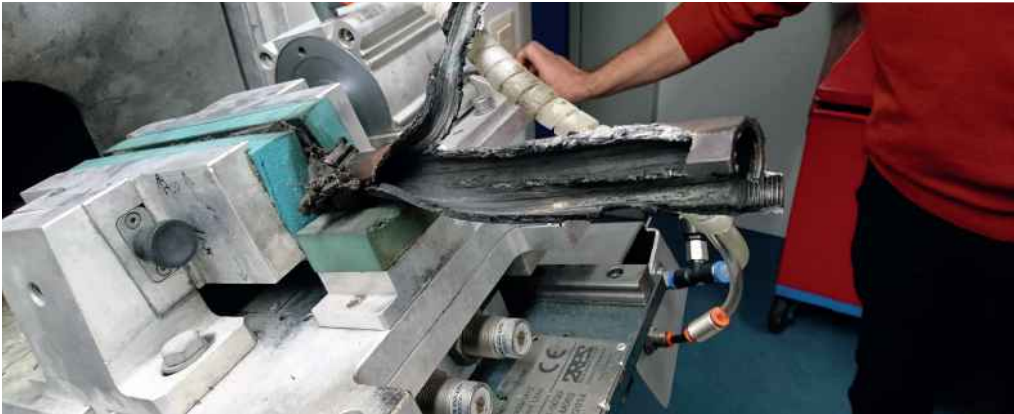
Eine, bei der Beschussprüfung, zerstörte Waffe Quelle: RP Tübingen
