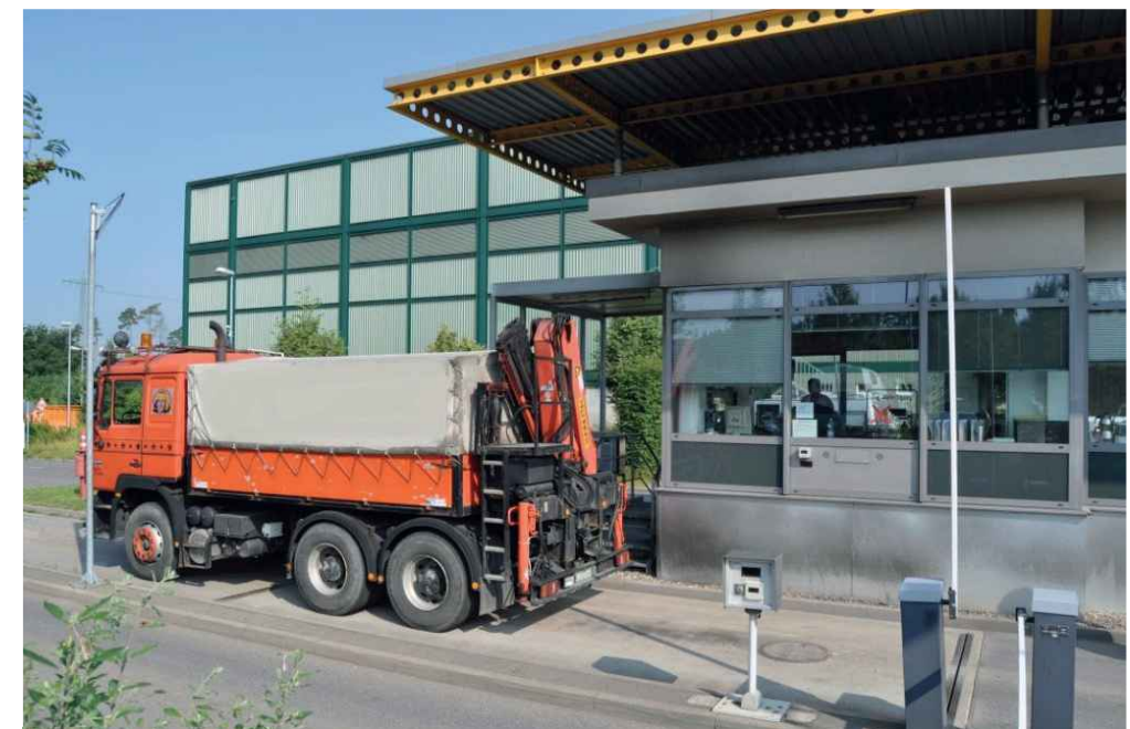
Eichung einer Fahrzeugwaage Quelle: RP Tübingen
