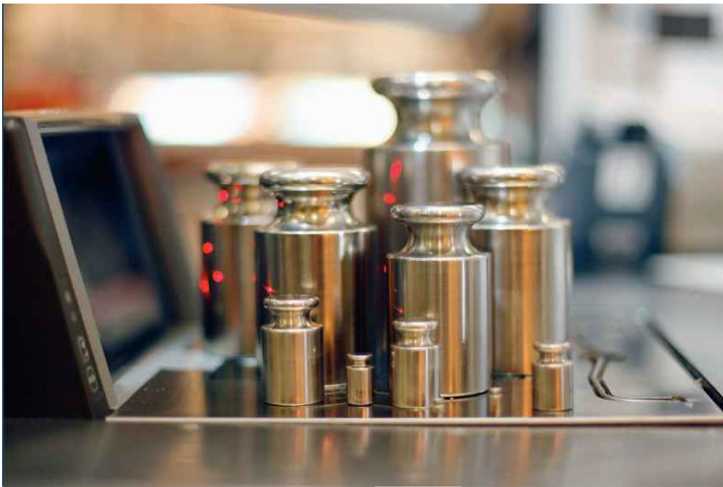
Prüfung einer Waage mit Gewichtstücken Quelle: RP Tübingen
