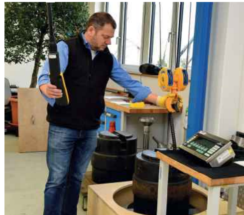
500 kg-Gewichtstück bei der Prüfung Quelle: Pacher / GEA
