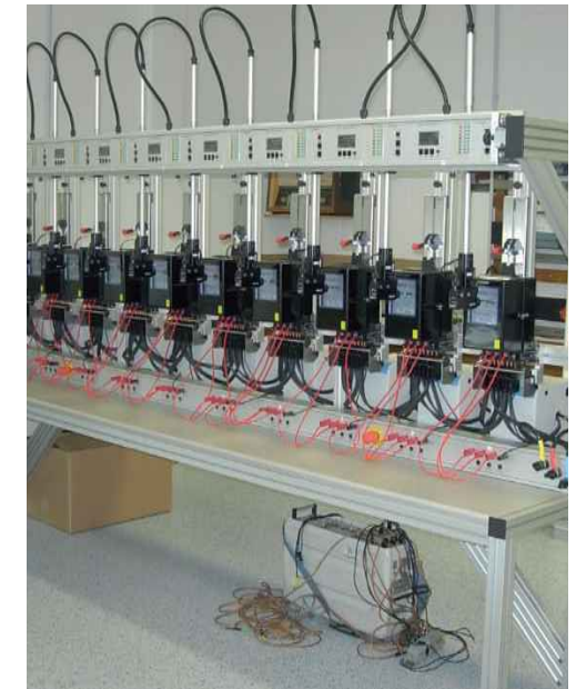
Prüfung von E-Zählern Quelle: RP Tübingen
